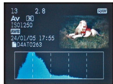
Abbildung 3.3 Der in die Kamera eingebaute Prozessor erzeugt die niedrigauflösenden JPEG-Vorschaubilder, die auf dem LCD-Bildschirm angezeigt werden. Das Histogramm basiert auch auf dieser JPEG-Vorschau, deshalb ist es eine schlechte Anzeige für das wirkliche Belichtungspotenzial eines unbearbeiteten Bildes.
