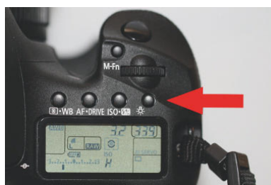
Die Lichttaste zur Speicherung eines AF-Feldes
