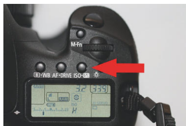
Die ISO-Taste zur Löschung eines gespeicherten AF-Messfeldes
