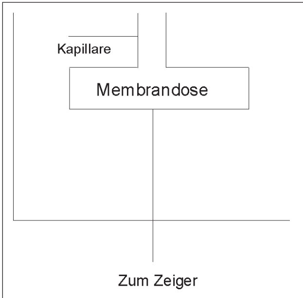
Abb. 3.15 Konstruktionsprinzip des Variometers
