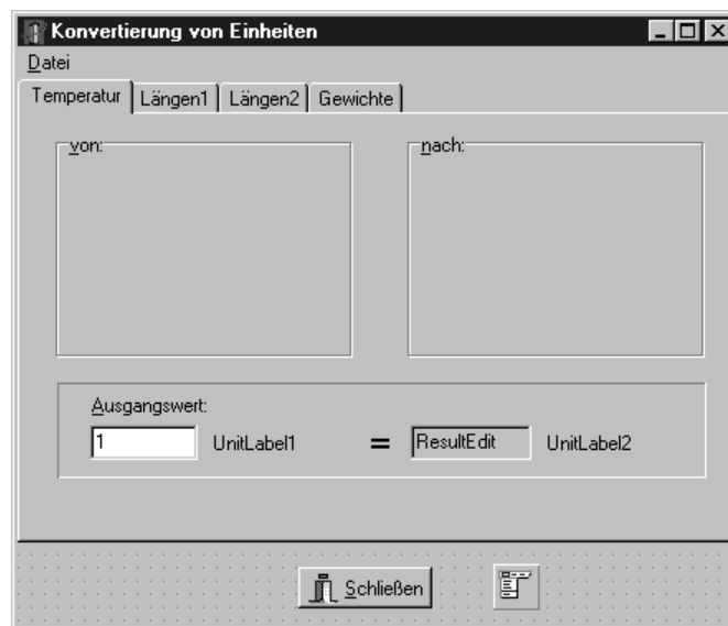
Abbildung 3.15: Die TabControl -Komponente zur Entwurfszeit
