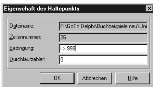
Abbildung 3.10: Definition eines bedingten Haltepunktes
