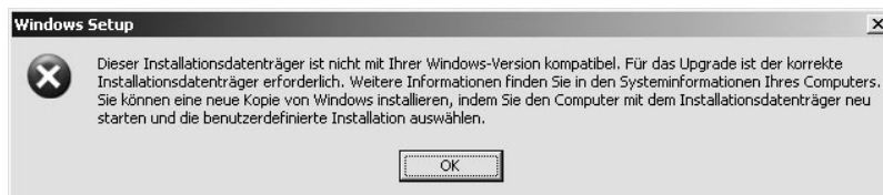
Abbildung 3.3: Ein Upgrade mit gleichzeitigem Wechsel der Prozessorarchitektur von x86 nach x64 ist nicht möglich
