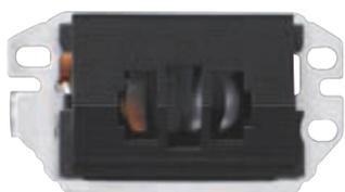
📌 Das AF-Modul der EOS 500D. Gut zu erkennen: Die Teilerlinse für die beiden Sekundärbilder. Foto: Canon
