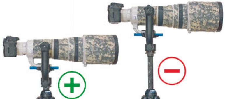
**Abbildung 3.4:** Schwere Teleobjektive geraten bereits bei schwachem Wind in Schwingung, sodass an scharfe Fotos kaum zu denken ist. Um größtmögliche Stabilität zu erreichen, sollte die Mittelsäule des Stativs nicht ausgezogen werden, da dies die Standfestigkeit des ganzen Systems heruntersetzt.
