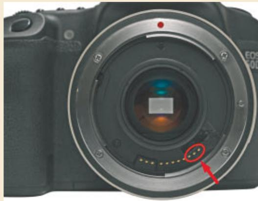
**Abbildung 3.7:** Durch Abkleben dreier Kontakte am 2x-Extender funktioniert der Autofokus auch mit Teleobjektiven wieder, deren Offenblende (Lichtstärke) 4 durch den Konverter auf 8 hochgeht. Der Fokus arbeitet jedoch langsamer und benötigt gute Lichtverhältnisse, um den Schärfepunkt in der Bildmitte zuverlässig zu treffen.
