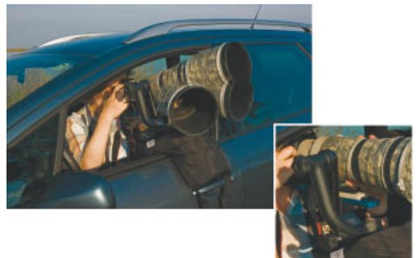
**Abbildung 3.21:** Mit der Stativplatte des Bohnensacks, die eine 3/8-Zoll-Anschlussschraube besitzt, lässt sich ein Kugelkopf (am besten ein flacher) oder sogar ein Wimberly Head auf dem Bohnensack montieren.
