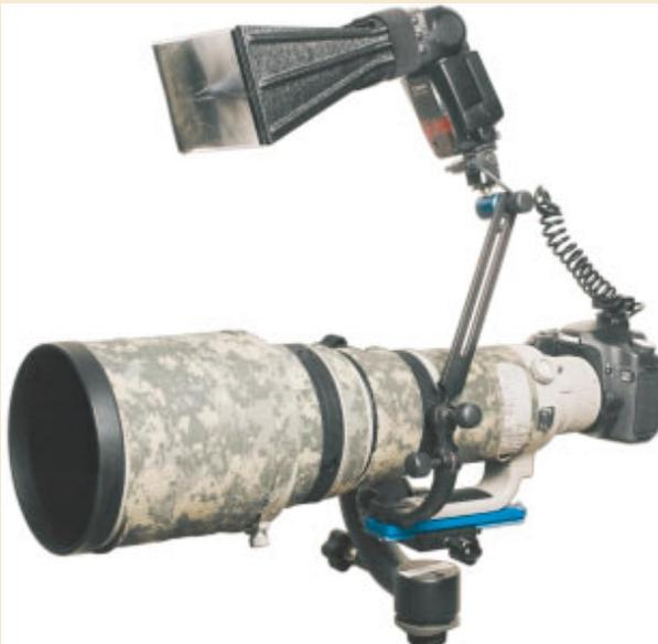
**Abbildung 3.32:** Canon EOS 50D mit EF 4/500 mm auf Wimberly Head II mit Speedlite 580EX II, Teleblitzvorsatz, Blitz-Synchronkabel, Mini-Kugelkopf und Blitzhalter (Kirk FB-9)
