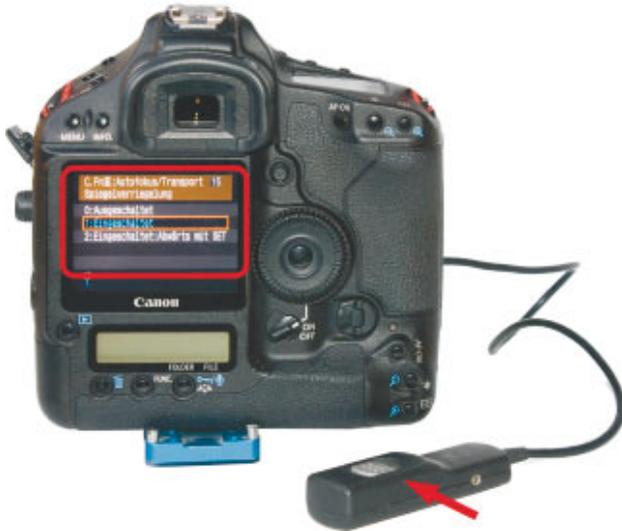
**Abbildung 3.5:** Bei Teleaufnahmen statischer Motive verwende ich möglichst immer einen Fernauslöser und aktiviere die Spiegelverriegelung, um jegliche Vibrationen zu vermeiden. Dabei warte ich zwischen dem ersten und zweiten Auslösen zur Sicherheit meist etwa eine Sekunde.
