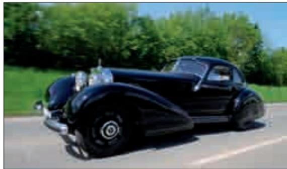
Vom Modell „Autobahn-Kurier“ fertigte Mercedes-Benz auf Basis der legendären 500 K und (ab 1936) 540 K insgesamt lediglich sechs Stück. Das hier gezeigte Exemplar stammt aus dem Jahr 1938 und wurde seinerzeit von einem spanischen Arzt bestellt. Die Sport-Limousine wird von einem 5,4-Liter-Reihenachtzylinder angetrieben, der dank zuschaltbarer Kompressoraufladung 180 PS leistet.
