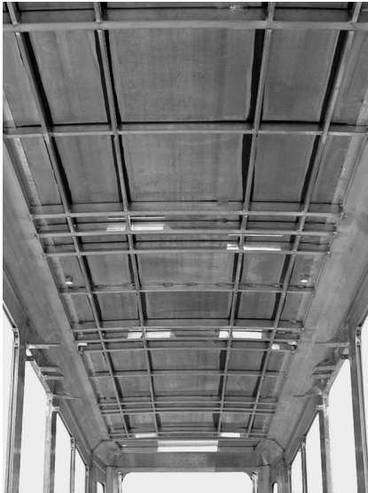
Abb. 1.2.1 Schubfelder im Dachaufbau eines Schienenfahrzeugs.
