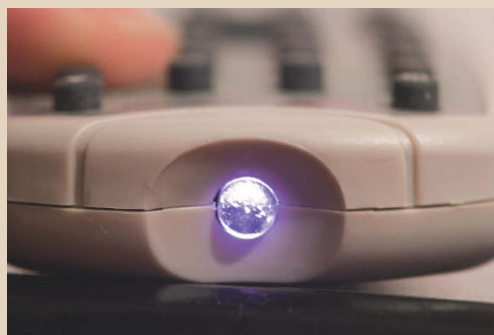
Bei ausreichender IR-Empfindlichkeit zeigt das Foto eine leuchtende IR-Diode. Aufnahmedaten: Nikon D70; manueller Belichtungssteuerung; Blende f/8; Belichtungszeit 10 s
