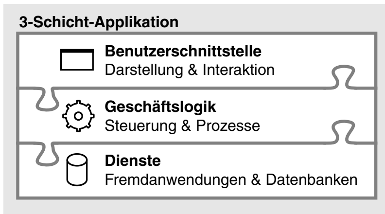
Abbildung 4.1 3-Schicht-Anwendungen trennen konzeptionelle Benutzeroberfläche, Anwendungslogik und fremde Dienste. WebObjects verbindet mit vorgefertigten Komponenten alle drei Teile.
