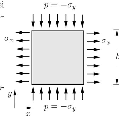
Einsetzen liefert die gesuchte Spannung  $\sigma_x$  und die Dehnung in  $y$ -Richtung:
