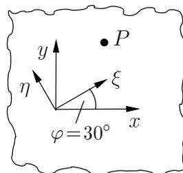
Wie groß sind die Hauptspannungen, die maximale Schubspannung sowie die Spannungen in Schnitten, die unter  $\varphi = 30^\circ$  zu den Hauptachsen geneigt sind?
