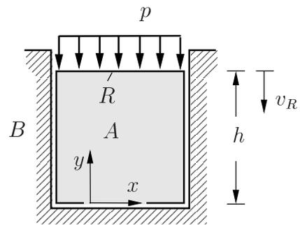
*Lösung:* In der Scheibe herrscht ein gleichförmiger ebener Spannungszustand, wobei die Spannung  $\sigma_y$  bekannt ist:  $\sigma_y = -p$ . Damit lautet das Elastizitätsgesetz
