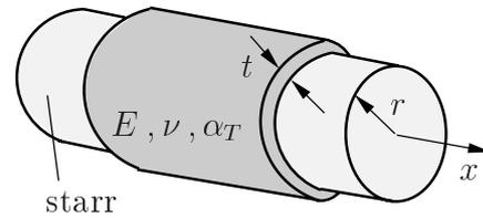
*Lösung:* Vor dem Abkühlen ist die Muffe spannungsfrei. Die Spannungen nach dem Abkühlen ergeben sich aus dem Gleichgewicht, dem Elastizitätsgesetz und der Kinematik. Die Gleichgewichtsbedingung liefert
