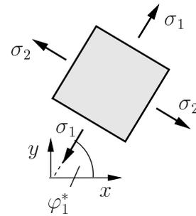
Zur Verdeutlichung ist es zweckmäßig, das durch die Hauptspannungen belastete Element zu skizzieren.
