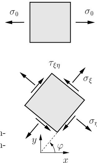
Wegen  $\tau_{xy} = 0$  sind die Spannungen  $\sigma_x, \sigma_y$  Hauptspannungen und die  $x$ - bzw.  $y$ -Richtung die Hauptrichtungen:
