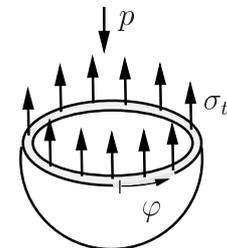
**Aufgabe 1.11:** Ein dünnwandiger Zylinderkessel aus Stahl wird durch den Innendruck  $p$  belastet.
