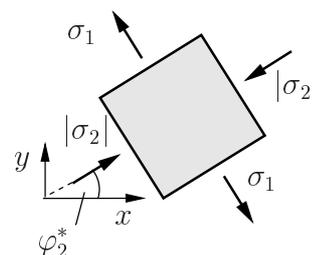
Welcher Winkel zu welcher Hauptspannung gehört, kann nur durch Einsetzen in die Transformationsbeziehungen bzw. am MOHRschen Kreis geklärt werden.
