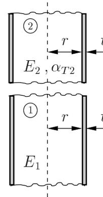
*Lösung:* Damit das Rohr ② auf die Welle ① geschoben werden kann, muss sein Radius durch Erwärmen um  $t$  vergrößert werden. Im erwärmten Zustand muss demnach die Umfangsdehnung den Wert
