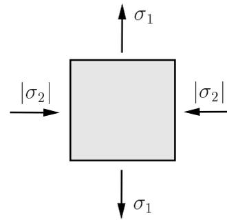
*Lösung:* **zu a)** Entsprechend der Skizze verwenden wir ein Koordinatensystem  $x, y$ , das mit den Hauptachsen zusammenfällt. Dann folgen die Spannungen in den um  $\varphi^a = 60^\circ$  gedrehten Schnitten aus den Transformationsbeziehungen zu
