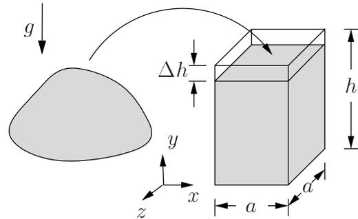
*Lösung:* Bei der gegebenen Beanspruchung treten nur Normalspannungen  $\sigma_x$ ,  $\sigma_y$  und  $\sigma_z$  in den drei Koordinatenrichtungen  $x$ ,  $y$  und  $z$  auf. Außer der Dehnung  $\varepsilon_y$  in  $y$ -Richtung sind keine Dehnungen vorhanden.
