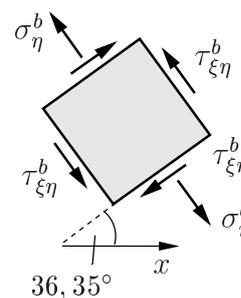
zu c) Die maximale Schubspannung tritt in Schnitten unter  $\pm 45^\circ$  zu den Hauptachsen auf. Sie hat die Größe
