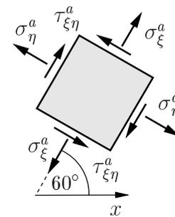
**zu b)** Damit die Normalspannung  $\sigma_\xi$  Null wird, muss gelten
