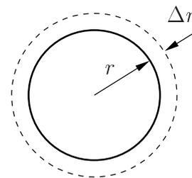
**Aufgabe 1.14:** Eine dünnwandige Muffe muss um die Temperaturdifferenz  $\Delta T^*$  erwärmt werden, damit sie auf eine Welle geschoben werden kann.
