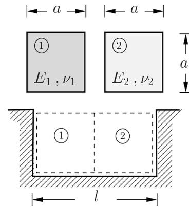
Wie groß sind die Spannungen und die Änderungen der Seitenlängen, wenn angenommen wird, dass die Scheiben an allen Rändern reibungsfrei gleiten können?
