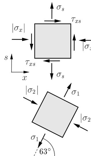
**Aufgabe 1.6:** In einem dünnen Aluminiumblech ( $E = 0,7 \cdot 10^5 \text{ MPa}$ ,  $\nu = 0,3$ ) werden im Punkt  $P$  die Verzerrungen  $\varepsilon_x = 0,001$ ,  $\varepsilon_y = 0,0005$ ,  $\gamma_{xy} = 0$  aus Messungen bestimmt.
