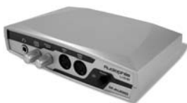
Abbildung 6.1 ▲ USB-Audioadapter von M-Audio mit MIDI-Schnitt- stellen und Kopfhörer- anschluss (© M-Audio)
