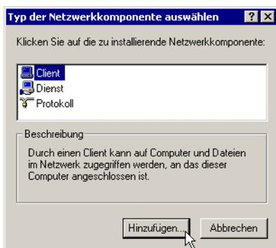
Zuerst müssen Sie Windows 2000 den Typ der neuen gewünschten Netzwerkkomponente mitteilen. Das Fenster, in Abbildung 3.16 gezeigt, bietet die Auswahl von **CLIENT**, **DIENST** oder **PROTOKOLL**. Komponenten von Drittanbietern installieren Sie über den Schalter **DATENTRÄGER** der jeweiligen Auswahlliste.
