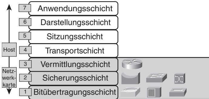
Abbildung 3.16: Jedes Gerät verfügt über spezielle Funktionen, die in den einzelnen Schichten des OSI-Modells verwendet werden.
