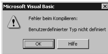
Abbildung 5.1 Die typische Fehlermeldung, wenn Sie die Referenz auf den XML-Parser vergessen haben
