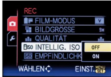
☞ Bei den Kameras der FS-Serie und bei der LZ10 wählen Sie einen ISOMAX-Wert aus, um die intelligente ISO-Korrektur zu aktivieren.
