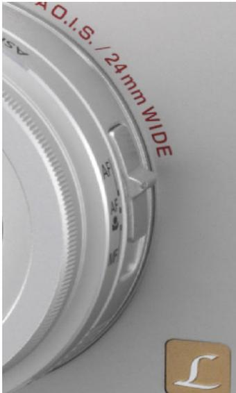
☞ Um auf manuellen Fokus umzuschalten, müssen Sie den Schalter am Objektiv nach unten auf MF schieben.
