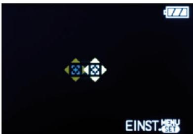
Verschieben des AF-Messpunktes bei der Spotmessung der LX3
