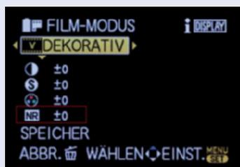
Die Einstellung NR (NR = Noise Reduction = Rauschreduzierung) können Sie erhöhen, um das Rauschen bei hohen ISO-Werten für einen bestimmten Filmtyp zu reduzieren
