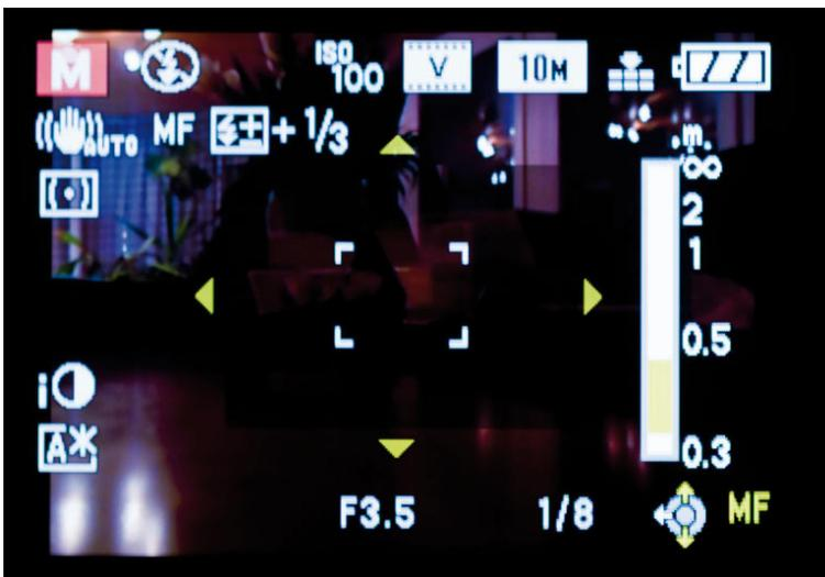
☞ Am Entfernungsmesser rechts sowie an den beiden MF-Symbolen erkennen Sie bei der LX3, dass der manuelle Fokus aktiviert ist.
