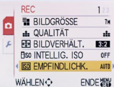
Über die Einstellung EMPFINDLICHK im Menü REC können Sie die ISO-Automatik bei allen Kameras aktivieren.
