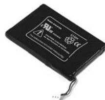
▲ Abbildung 2.6 Hieraus zieht iPod seinen Saft: Den Lithium-Polymer-Akku hat Apple bei Sony eingekauft. Das Bauteil dürfte bald für Verdruss sorgen. Denn angeblich gibt die Batterie nach etwa 500 Ladezyklen ihren Geist auf. Der Countdown für Altgeräte läuft also ...
