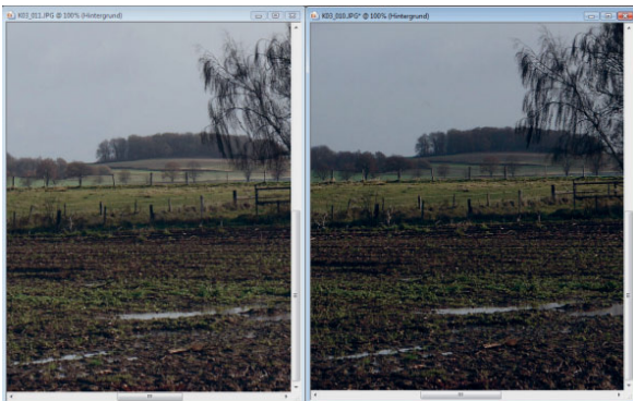
📍 Zwei 100%-Ausschnitte zum Vergleich. Im rechten mit Blende 8 sind die Schärfe, Farbsättigung und der Kontrast deutlich besser.
