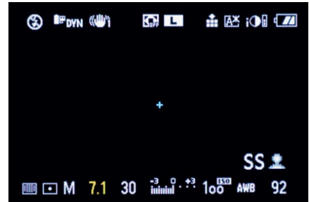
📌 Hier ist der Blendenwert gelb hervorgehoben, ihn können Sie nun durch Drehen am vorderen Wahlrad verändern.
