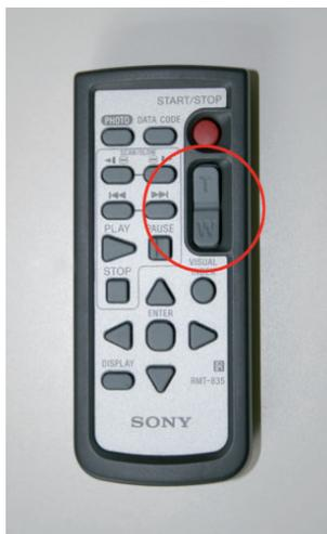
**Abbildung 3.3:** Der Zoom kann auch über die Fernbedienung gesteuert werden
