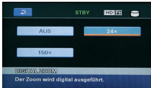
Abbildung 3.10: Im Menü DIGITAL ZOOM kann der maximale Zoomfaktor des digitalen Zooms festgelegt werden
