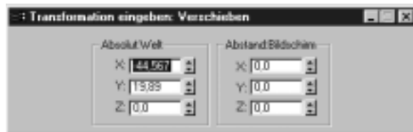
Bild 3.4: Das Dialogfenster Transformation eingeben , in dem Sie für die aktuell ausgewählte Transformation spezifische Werte eingeben können.
