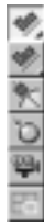
Bild 3.10: Das Flyout mit den anderen Befehlen zum Ausrichten von Objekten. Beispiele sind Normalen ausrichten, Glanzpunkt platzieren, Kamera ausrichten und An Ansicht ausrichten.
