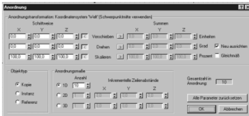
Bild 3.11: Das Dialogfenster Anordnung , mit dem Objekte im Raum kopiert und relativ zueinander verteilt werden können.
