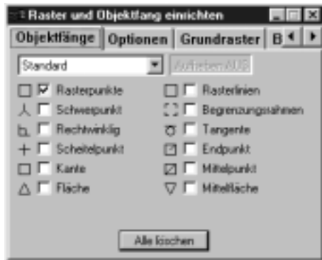
Bild 3.1: Das Dialogfenster mit den Optionen für Objektfangsysteme und Raster. Suchen Sie sich hier ein Objektfangsystem für die weitere Arbeit an der Szene aus.
