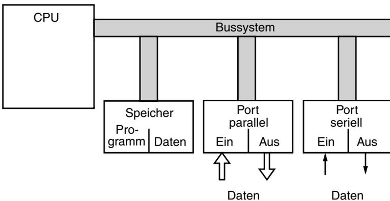
Ein Mikrocomputer besteht aus einer zentralen Prozess-Einheit CPU, die über ein Bussystem mit dem Speicher und den Eingabe- und Ausgabeeinheiten verbunden ist.
