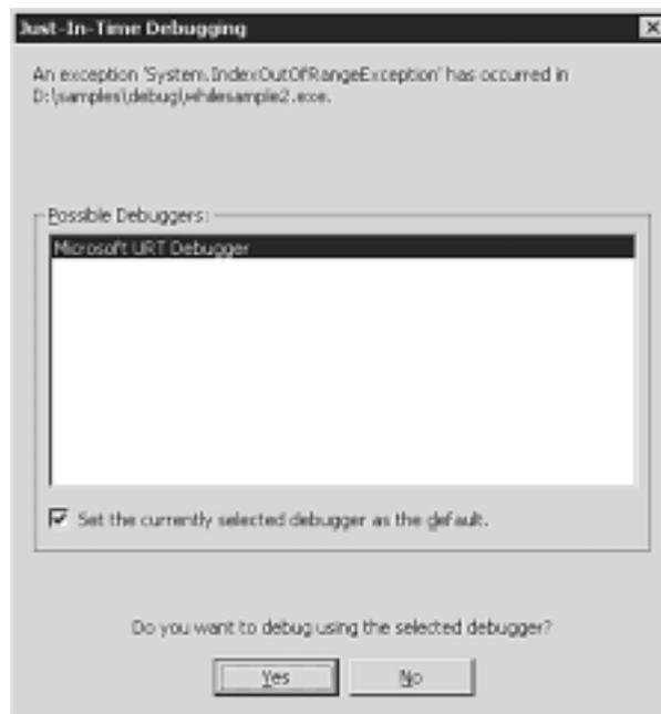
**Bild 11.9:** Das Dialogfeld *Just-in-Time Debugging* erscheint bei Auftreten einer unbehandelten Ausnahme
