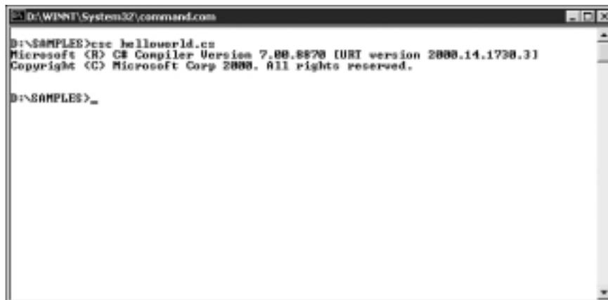
**Bild 3.2:** Die Anwendung mit dem Kommandozeilen-Compiler `csc.exe` übersetzen
