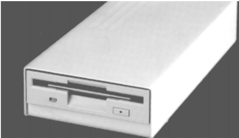
Bild 2.20: Das LS120-Laufwerk als externes Gerät für den Anschluss an den Parallel Port des PCs
