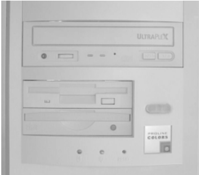
Bild 2.25: Bei diesem PC ist ein internes ZIP-Laufwerk standardmäßig unter dem Diskettenlaufwerk eingebaut, denn es kann das Diskettenlaufwerk nun mal nicht ersetzen
