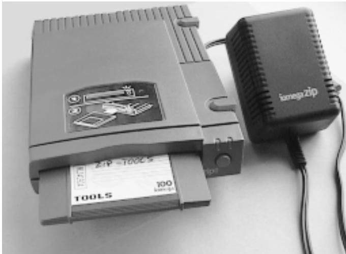
Bild 2.27: Das externe ZIP-Laufwerk mit ZIP-Disk für den Anschluss an den Druckerport und das dazugehörige Steckernetzteil
