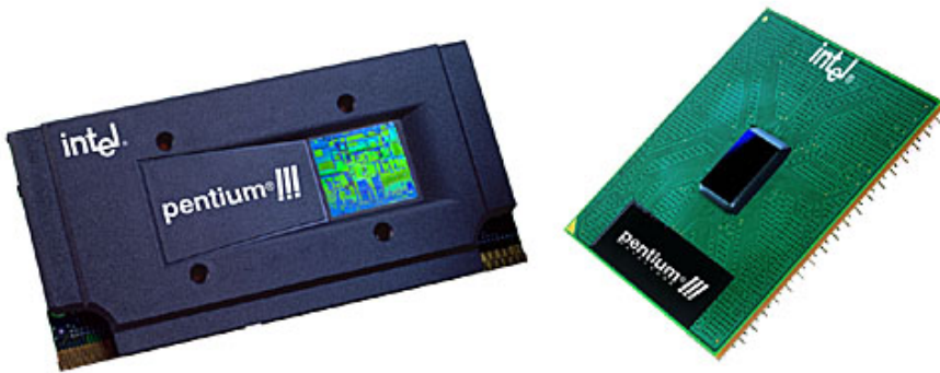
Abbildung 3.46 Pentium-III-Prozessor im SECC2- und FCPGA-Gehäuse
