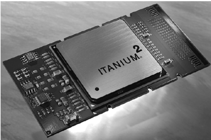
Abbildung 3.58 Der Itanium 2 verfügt über ein kompakteres Design als der Original-Itanium
