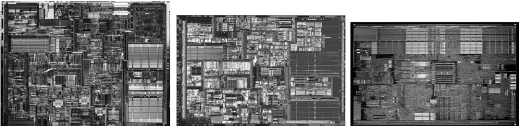
Abbildung 3.55 Die CPU-Dies des Pentium 4 (Willamette, Northwood, Prescott)
