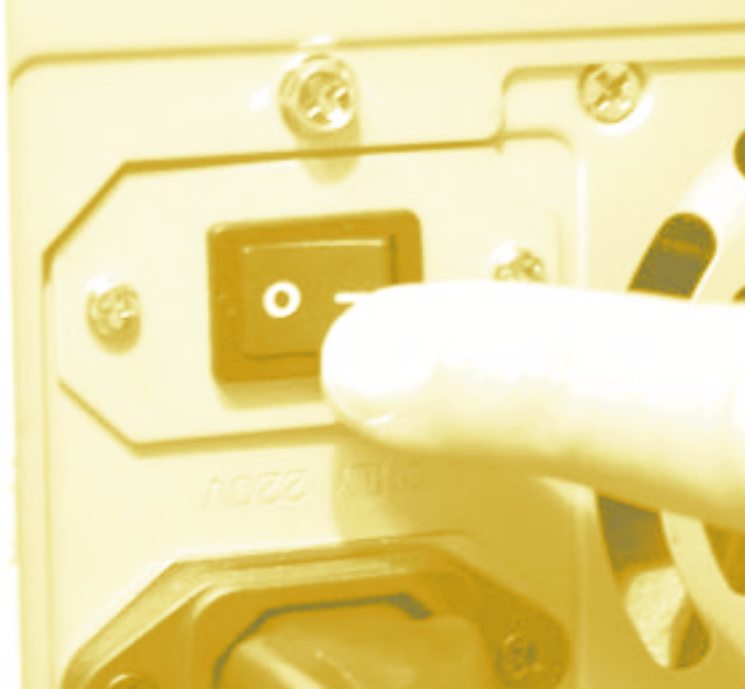
Abbildung 3.24: Vergessen Sie nicht, den An-/Ausshalter wieder auf 1 zu schalten, damit der Rechner hochgefahren werden kann.
