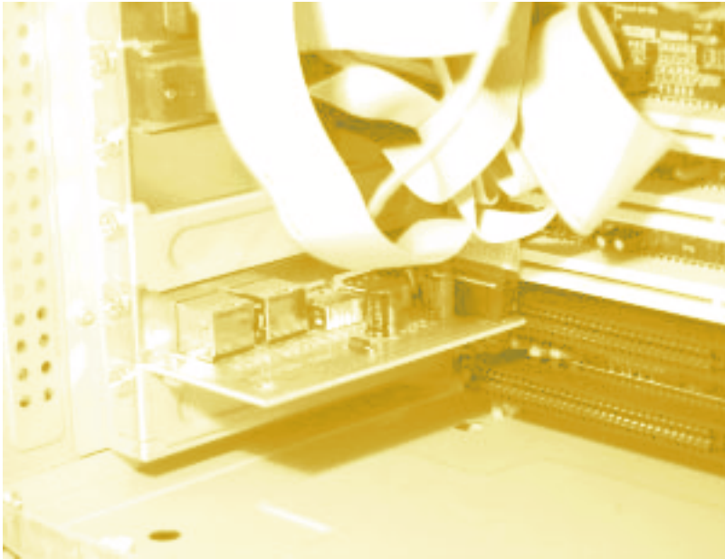
Abbildung 3.19: Bei diesem PC sind zwar schon viele Blenden belegt, aber auch die freien (unterste und dritte von unten) lassen sich einfach heraus-schrauben.
