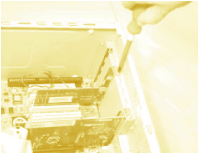
Abbildung 3.21: Die gerade eingebaute Karte wird mit dem Gehäuse verschraubt.
