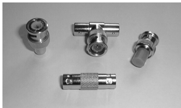
Bild B.2: Von links nach rechts: BNC-Stecker, BNC-T-Stück, BNC-Abschlusswiderstand und unten eine BNC-Kupplung
