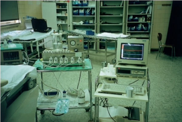
Abb. 2.1a–e. Messplatzanordnung für stationäre Manometrie. a Perfusionspumpe, b Druckwandler, c Analog-Digital-Konverter, d PC mit Drucker, e Messsonde
