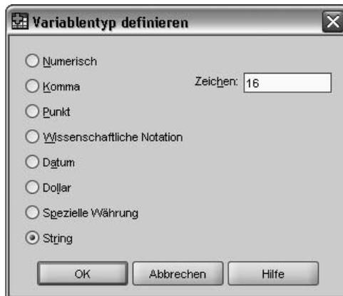
Abbildung 1.8: Datentyp *String* für eine Textvariable mit maximaler Zeichenlänge von 16
