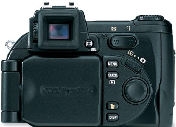
Die Rückseite der Coolpix 5700. Der LCD-Monitor wird unter dem Sucher ausgeklappt, außerdem sehen Sie die Zoomsteuerungen.
