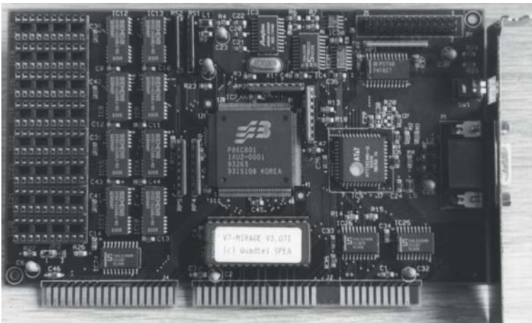
Abbildung 3.2: Eine der ersten Grafikkarten mit 2D-Beschleuniger der Firma S3
