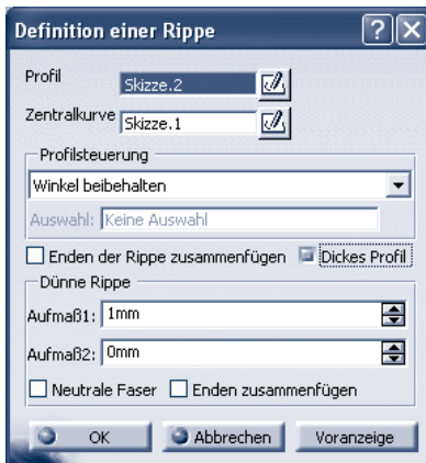
Abbildung 3.23: Erzeugtes Aufmaß durch die Option Dickes Profil
