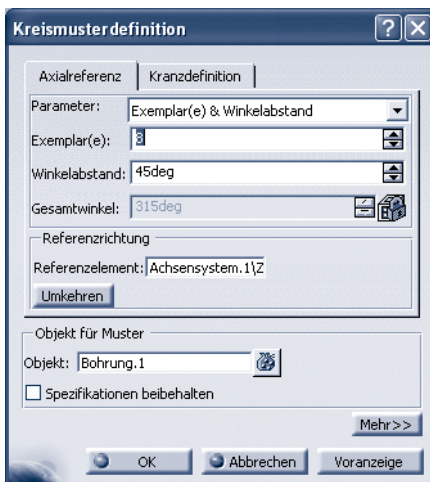
Abbildung 3.43: Kreismuster mit acht Bohrungen erzeugt
