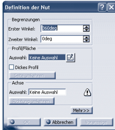
Abbildung 3.18: Skizze sowie die Rotationsachse müssen gewählt werden
