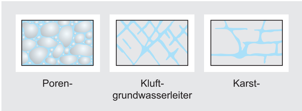
Abb. 5: Poren-, Kluft- und Karstgrundwasserleiter.
