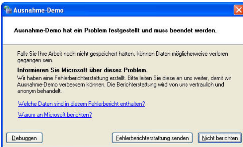
Abbildung 56: Meldung der CLR bei einer unbehandelten Ausnahme in einer WPF- oder Konsolenanwendung oder in einer Windows.Forms-Anwendung, die zum Debugging eingestellt ist
