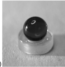
Kugel und Sitz einzeln, so sie in Gehäuse und Kartusche enthalten sind.
