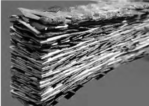
Abb. 6.2. Blätter-Technik: Nach teilweiser Verkokung der Matrix lassen sich die Schichten aufblättern und Faserbrüche und Zwischenfaserbrüche studieren
