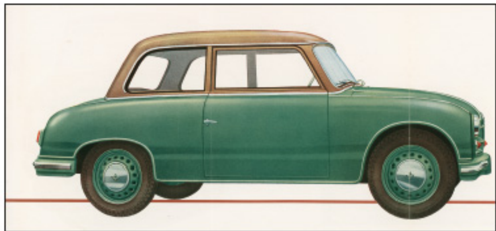
Ebenfalls vom 55er Prospekt stammt dieses Bild eines Nullorientfahrzeugs mit starr im Rahmen sitzender Türschiebe. Die schlechten Lüftungsverhältnisse im Innenraum machten Kurbel Fenster in der Serienproduktion notwendig.
