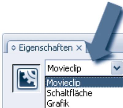
Sie ändern über dieses Bedienfeld das Verhalten der Instanz, indem Sie in dem Auswahlfeld neben dem Instanzsymbol die Art der Instanz auswählen.
