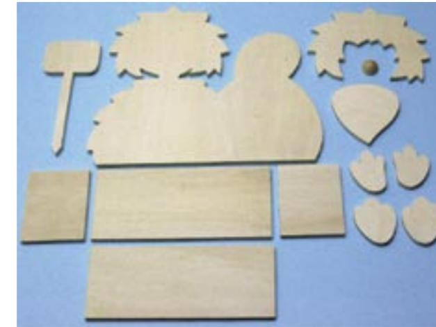
**1** Sämtliche Einzelteile aus Sperrholz aussägen und die Kanten abschmirlen.
