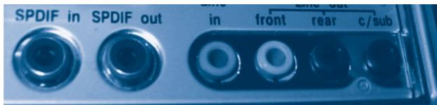
Die hier gezeigte, mit »front« bezeichnete Buchse eines 5.1-Audioausgangs versorgt entweder einen Stereolautsprecher oder den vorderen linken und rechten Lautsprecher. Mit der »rear«-Buchse werden die hinteren zwei Lautsprecher angesteuert. Das Kürzel »c/sub« steht für »center« (vorderer Center-Lautsprecher) und den Subwoofer für die Bässe.
