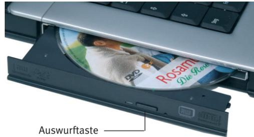
Die Schublade weist bei normalen CD-/DVD-Laufwerken und Brennern eine Vertiefung auf, in die das Medium hineinpasst. Bei Notebooks muss die CD bzw. DVD dagegen auf eine Art Fixierungsdorn aufgesteckt werden.
