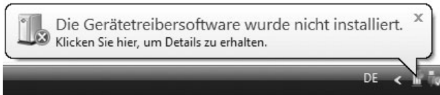
Bild 3.10: Anzeige bei fehlerhafter Geräteinstallation
