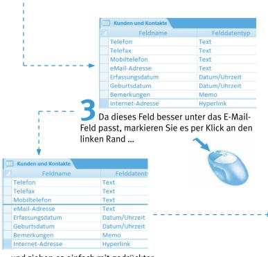
... und ziehen es einfach mit gedrückter Maustaste an die neue Position.
