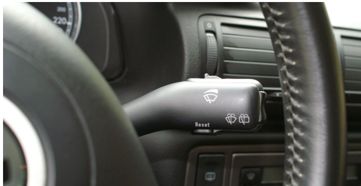
Abbildung 4.9 Eingebauter Lenkstockhebel für Wischerbetätigung. Der korrekte Betätigungsabstand wird durch das Lenkrad vorgegeben. Durch den langen Hebel erhöht sich zudem der Greifbereich, innerhalb dessen das Drehmoment nur unerheblich schwankt.
