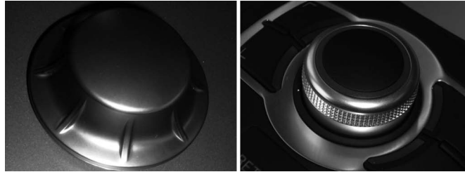
Abbildung 4.6 Links: Kegelförmige Kappe aus Kunststoff beim BMW iDrive im 5er; rechts: zylindrischer Grundkörper aus Aluminium beim Audi MMI des A8
