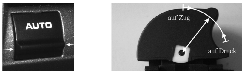
Abbildung 4.10 links: Einseitig ausgeführte Tastwippe mit haptisch kodierter Kappe bei Porsche, rechts: Tastwippe eines Audi-Fensterheber-Bedienelements. Die Bewegung läuft bogenförmig um die Drehachse. Es kann sowohl auf Zug als auch auf Druck sowie ein- und zweistufig getastet werden.
