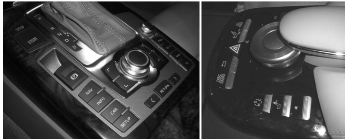
Abbildung 4.1 Moderne zentrale Bedienelemente: links das MMI im Audi A6, rechts das COMAND-System der Mercedes S-Klasse
