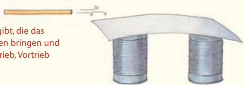
Wenn man nun mit dem Strohhalm an der Oberseite des Papierbogens Luft entlangbläst, biegt sich das Papier nach oben durch! Es wird von der schnell strömenden Luft nach oben gesogen. Das ist der Auftrieb!
