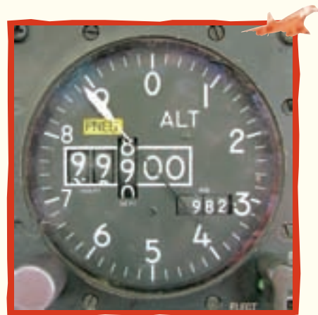
Das ist ein Höhenmesser, auch Altimeter genannt. Dieses Gerät misst mithilfe der Luftdruckunterschiede die Flughöhe.
