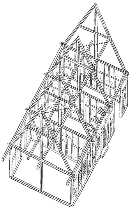
Gefüge eines niederdeutschen Zweiständerhallenhauses, dreischiffig mit der Erschließung vom Giebel
