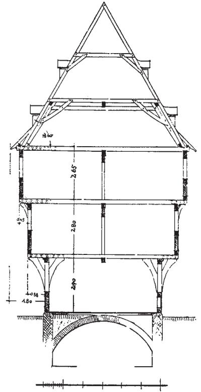
rechts der Querschnitt eines spätgotischen Stockwerkbaues aus der Frankfurter Altstadt
