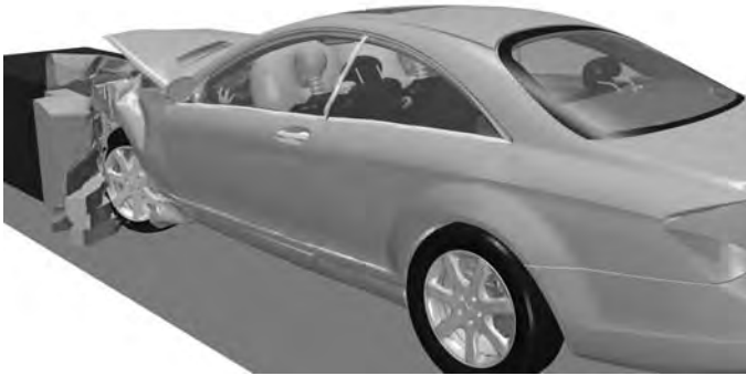
Abb. 9.23. Simulationsergebnis für einen ODB-Frontalcrash (Quelle: Daimler-Chrysler AG).
