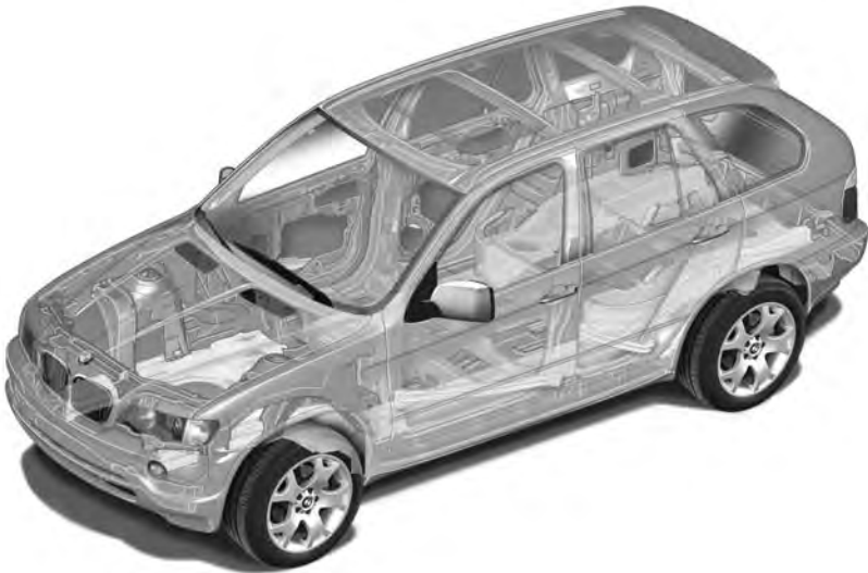
Abb. 9.15. Verteilung unterschiedlicher Stähle in der Sicherheitskarosserie des BMW X5 (Quelle: BMW).
