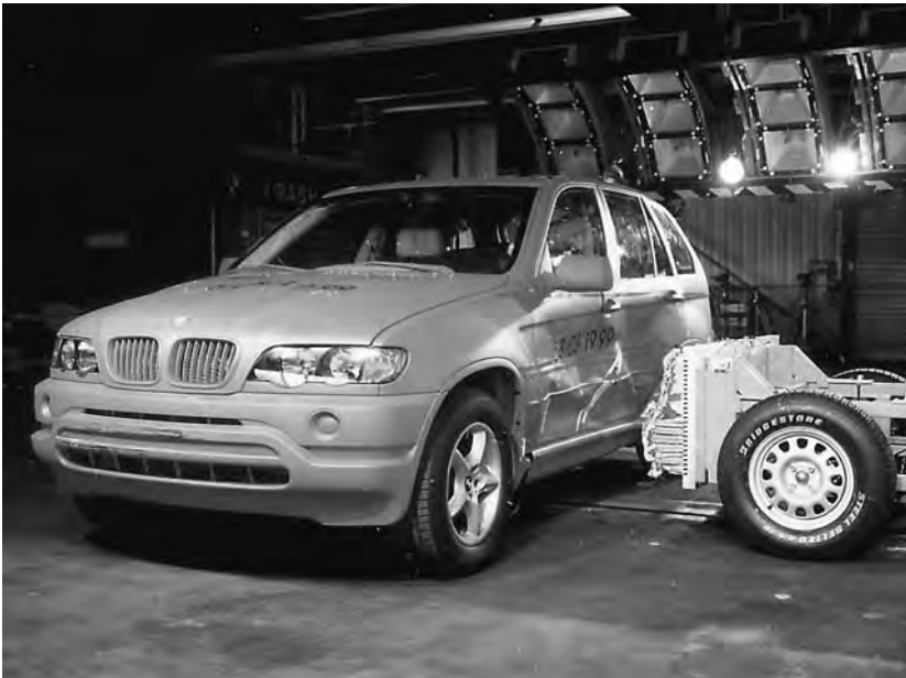
Abb. 9.24. Seitencrash eines BMW X5 (Quelle: BMW).
