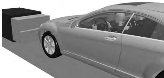
Abb. 9.22. Konfiguration ODB-Crash (Quelle: Daimler-Chrysler AG).
