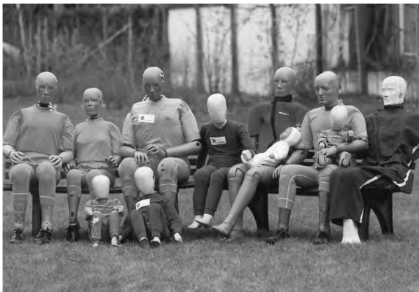
Abb. 9.16. Unterschiedliche Dummies für verschiedene Crasharten und für verschiedene Körpergrößen (Quelle: AUTOLIV).
