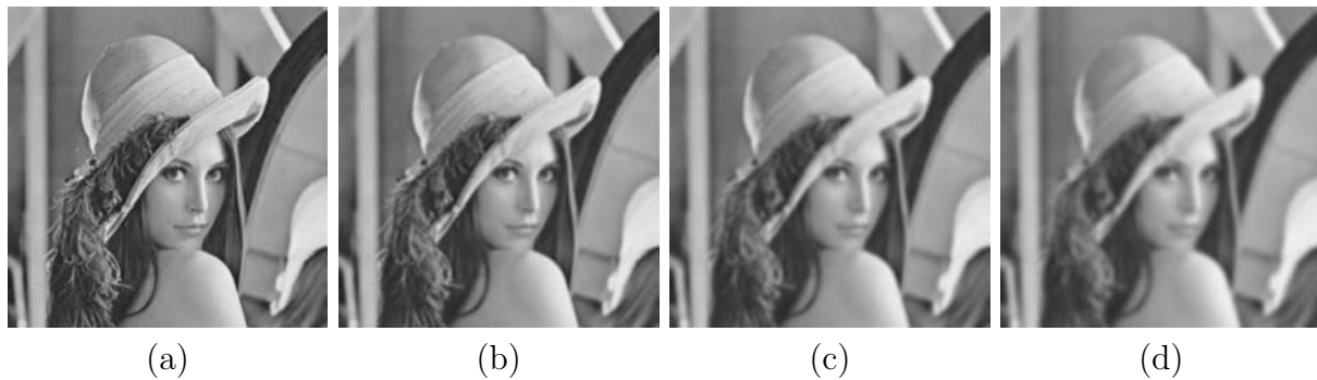
Bild 20.13: Auswirkungen unterschiedlicher Standardabweichungen zum Glätten des Bildes: (a) \sigma = 1.0 , (b) \sigma = 2.0 , (c) \sigma = 3.0 , (d) \sigma = 4.0 ,
