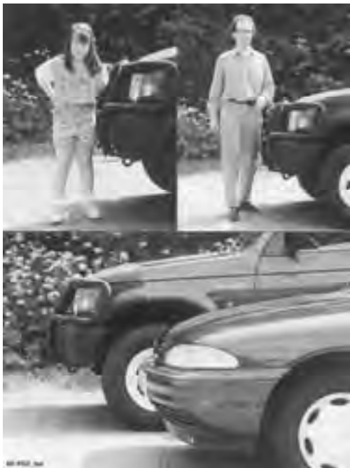
Abb. 4.19 Darstellung der Größenverhältnisse an einer Pkw- und Geländewagenfront für ein Kind und einen Erwachsenen (nach Zellmer u. Schmid 1993).
