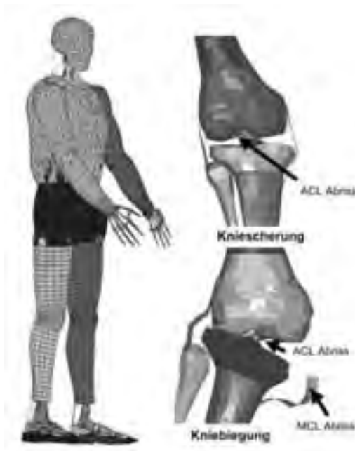
Abb. 4.6 Das von Toyota entwickelte THUMS-Fußgänger-Modell. Besondere Beachtung fand die realistische Modellierung des Bänderapparates im Knie, um Verletzungen durch Biegung und Scherung realistisch abbilden zu können (Toyota Central R&D Labs 2006).
