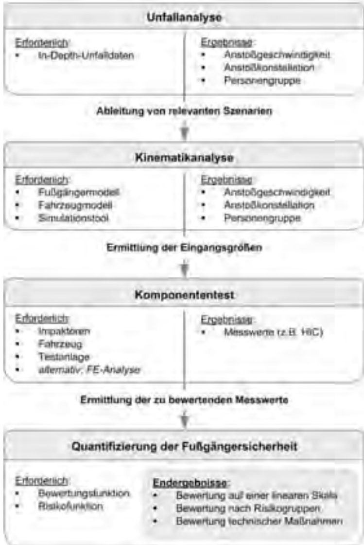
Abb. 4.31 Darstellung der Methodik zur Bewertung des fahrzeugseitigen Fußgängerschutzes.
