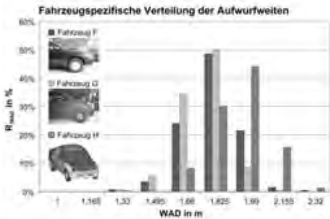
Abb. 4.33 Mittels der Kinematikanalyse durchgeführte Transformation der Fußgängergrößenverteilung in eine errechnete fahrzeugspezifische Verteilung der Aufwurfweiten (WAD) für Kinder über 12 Jahre sowie Erwachsene für die Beispielfahrzeuge F, G und H.
