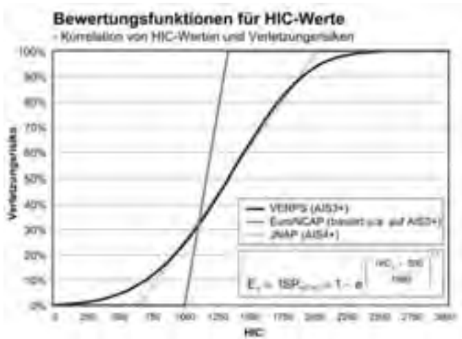
Abb. 4.32 Empirischer Zusammenhang zwischen gemessenem HIC-Wert und der Wahrscheinlichkeit des Eintretens von AIS3+-Kopfverletzungen (ISP - Injury Severity Probability) (ISO 13232). Zum Vergleich sind die Bewertungsskalen des EuroNCAP und JNCAP eingetragen.
