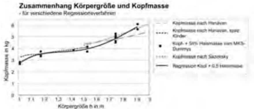
Abb. 4.7 Zusammenhang zwischen Körpergröße und Kopfmasse für verschiedene Regressionsverfahren. Zusätzlich sind Kopfmassen (inkl. 50 % der Halsmasse) aktueller TNO-Dummymodelle eingetragen (nach Fröming 2003).
