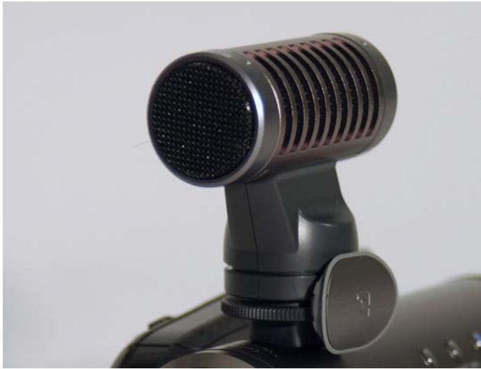
Abbildung 3.21: Das optional erhältliche Mikrofon ECM-HQP1 zeichnet vier Kanäle gleichzeitig in Surround auf.
