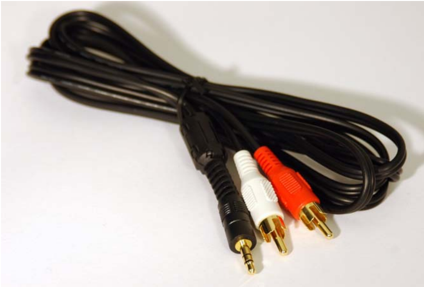
Abbildung 3.31: Stereo-Cinch-Stecker mit einem Übergang auf Mini-Klinke.
