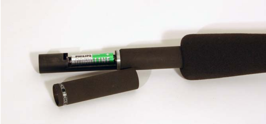
Abbildung 3.14: Das Richtmikrofon wird über eine Batterie mit Strom versorgt.
