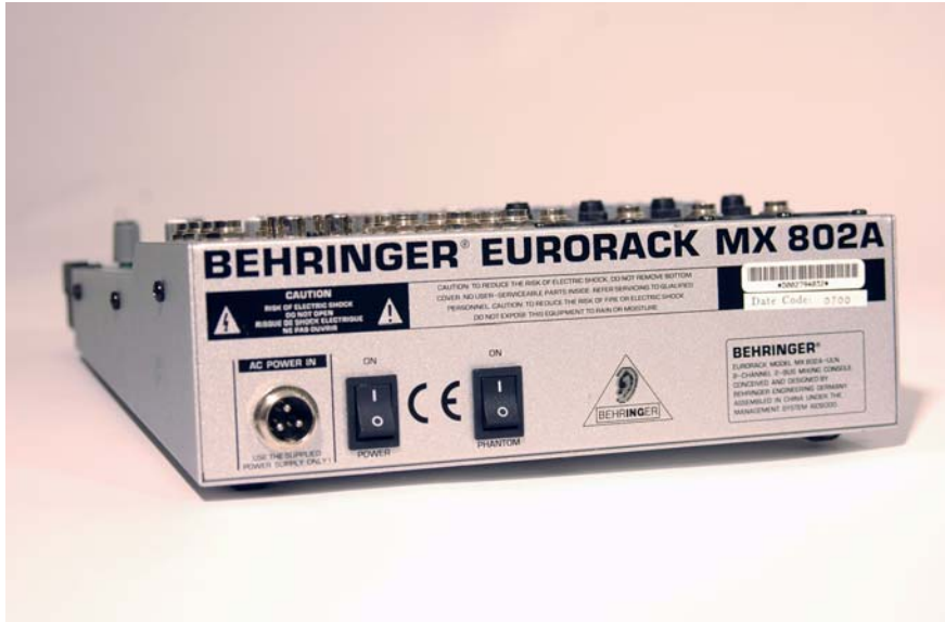
Abbildung 3.13: Anschluss für Phantomspeisung am Audio-Mischpult
