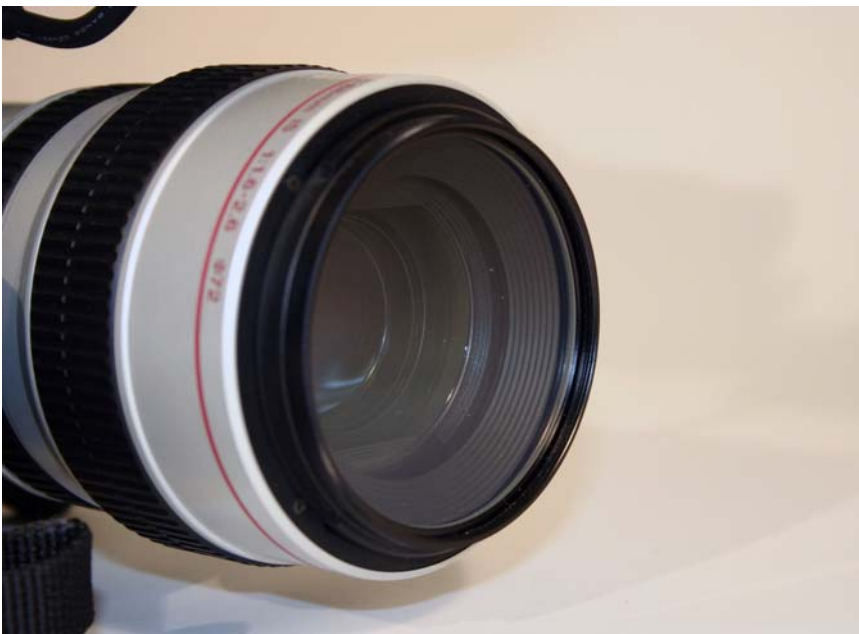
Abbildung 3.35: Filter werden direkt auf das Objektiv geschraubt.
