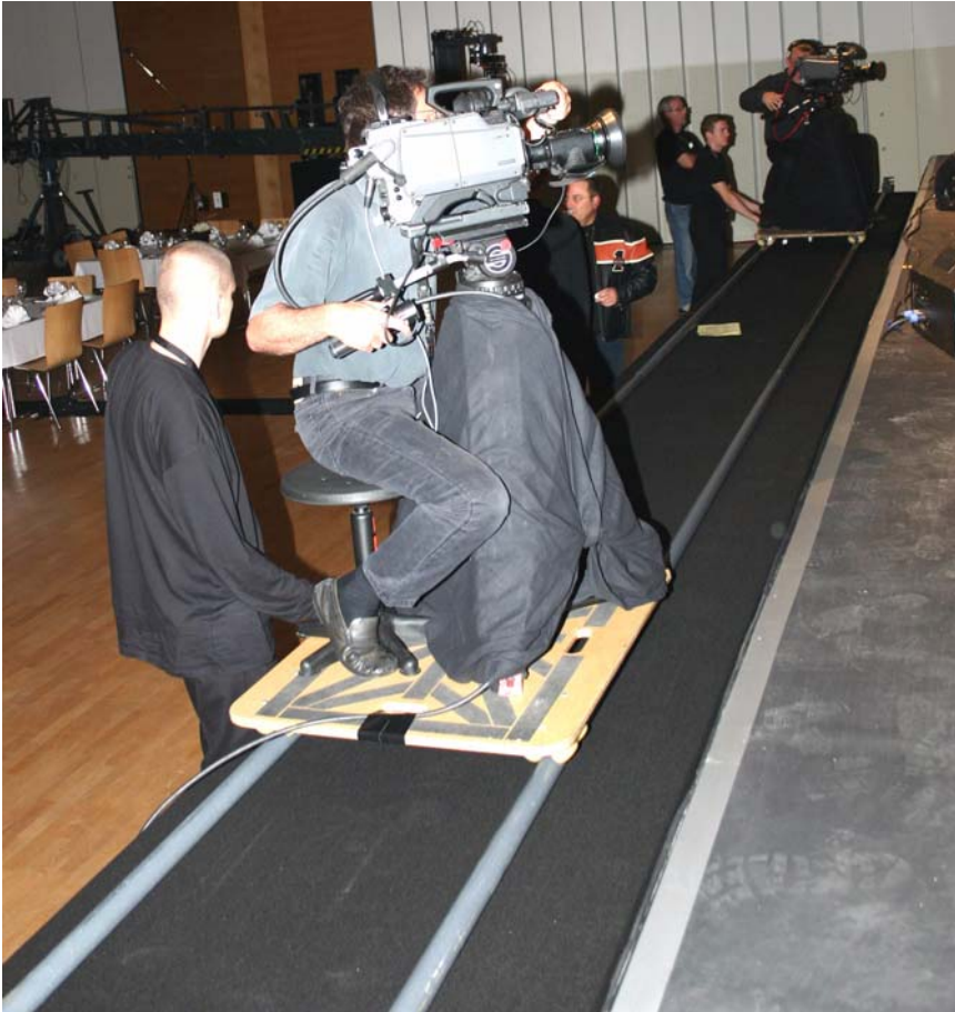
Abbildung 3.62: Kamerawagen mit Kameramann auf einem Dolly mit Schienensystem
